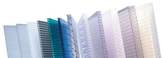
Makrolon® multi UV 5M/25-20 ist eine Stegplatte aus Polycarbonat mit einer Dicke von 25 mm und einer M-Struktur, die für höhere Steifigkeit sorgt. Sie vereint gute Lastabtragung und gute Wärmedämmung mit Lichtdurchlässigkeit und ausgezeichnete Witterungsbeständigkeit. Die Platte ist leicht, schlagzäh und einfach zu verlegen.
